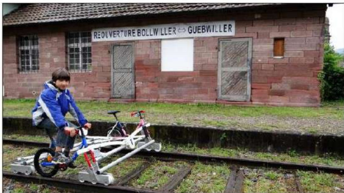
Thomas Hubert a conçu et construit un vélo-rail à deux places ultraléger qui peut circuler sur des tronçons de rail désaffectés.
