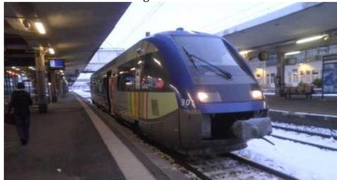
Ci-dessus un autorail TER X 73900. Il se différencie de la série X 73500 par son équipement de systèmes de signalisations et de sécurités nécessaires à la circulation en Allemagne. Il se trouve au départ au quai n°4 de la gare de Mulhouse à 8 h 19 et à destination de Müllheim. Le nœud ferroviaire et le détour par Bâle sont évités. Un TGV Fribourg – Paris circulera sur cette ligne dès août 2013.
